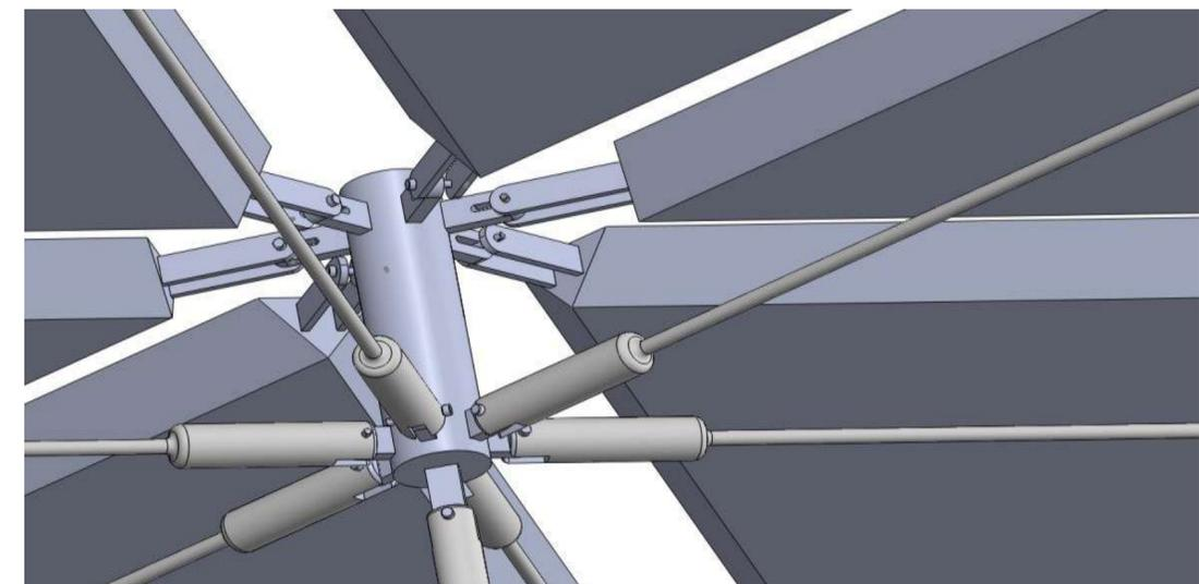
Un nodo de la malla de cables que va por debajo de los paneles reflectantes
