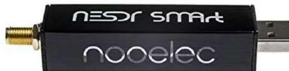
Figura. Dispositivo (dongle) SDR que permite digitalizar la señal recibida por nuestro radiotelescopio.
