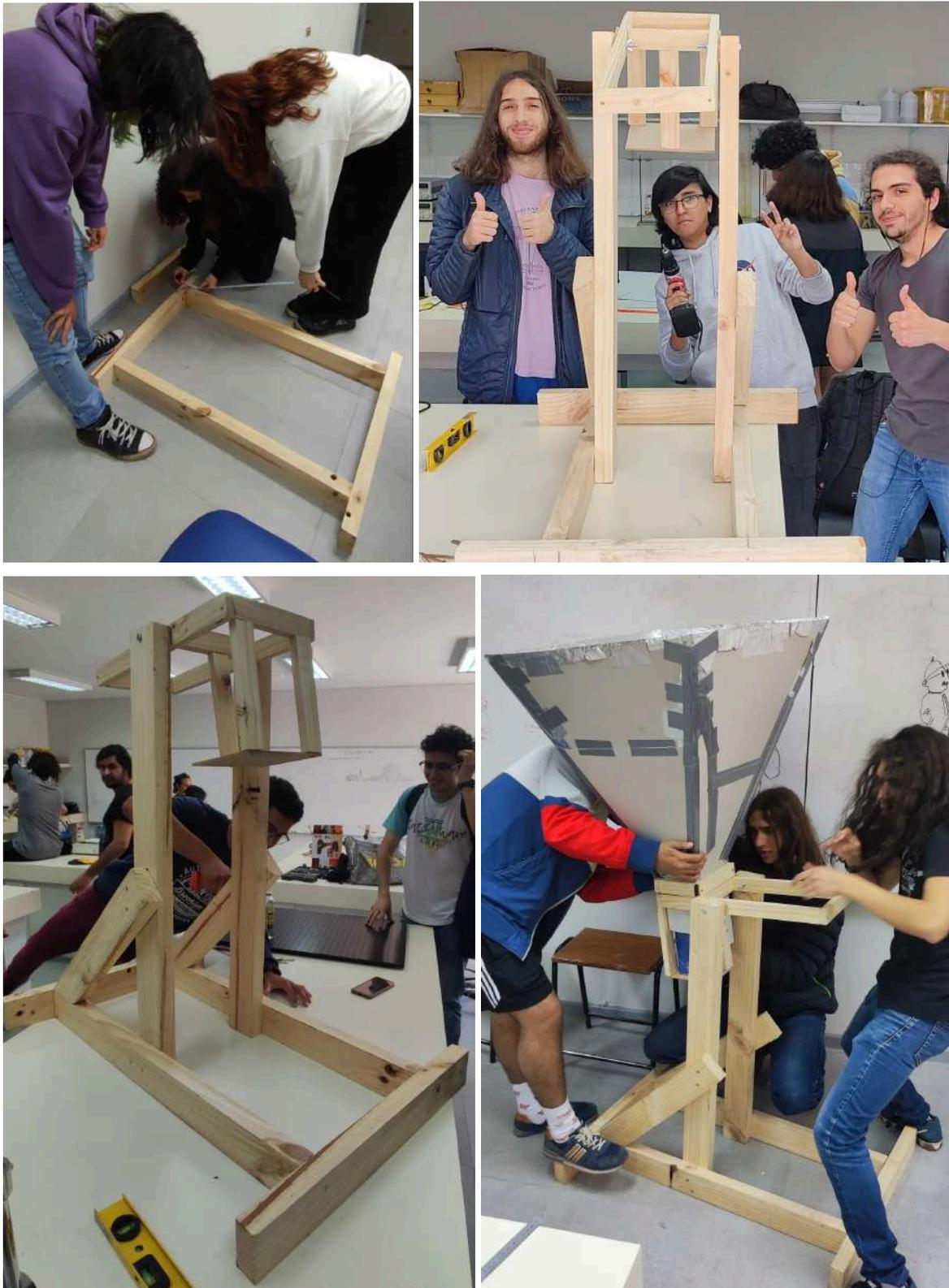
Figura. Dos ejemplos de base para el radiotelescopio. 1
