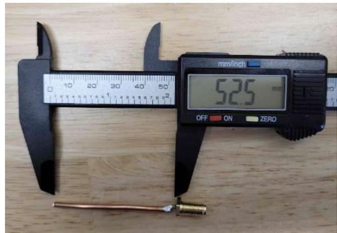
Figura XX. Soldando el cable de cobre al conector coaxial. **Luego, cortando el cable para que quede exactamente con  $\lambda/4$  de largo. Nota: considerar el grosor de la guía de ondas.**
