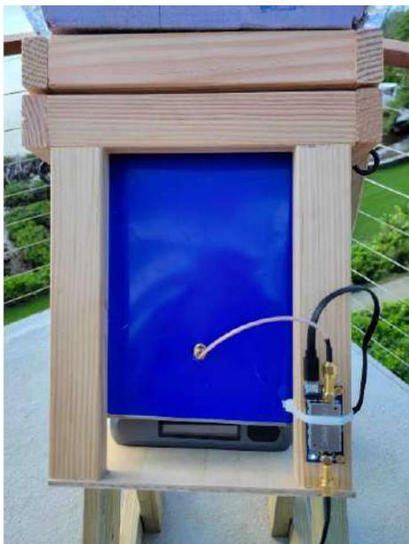
Asegúrate de que la antena esté conectada a la entrada del amplificador. Es el mismo lado por donde entra la alimentación. Es fácil cometer errores en esto, y puede llevar a problemas como que no se vea inicialmente la línea HI.
