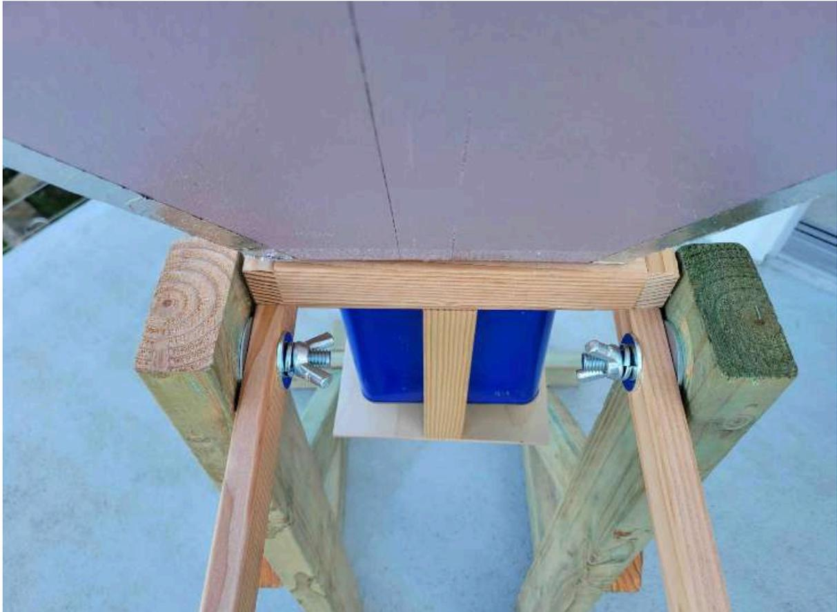
Figura XX. Conexión entre el soporte del cuerno y la base. Notar que el uso de arandelas autorroscantes ayuda a mantener el telescopio apuntando hacia la dirección deseada.
