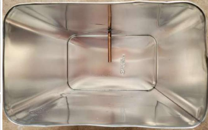
Figura XX. (Izquierda) Perforar el agujero para el conector que se conectará a la lata. El agujero se encuentra en el centro del lado ancho de la lata y a una distancia de  $\lambda/4$  desde el extremo cerrado. (Derecha) Así se debería ver la antena al mirar dentro de la guía de ondas. Notar que la longitud del cable que se asoma debe ser exactamente igual a  $\lambda/4$ .
